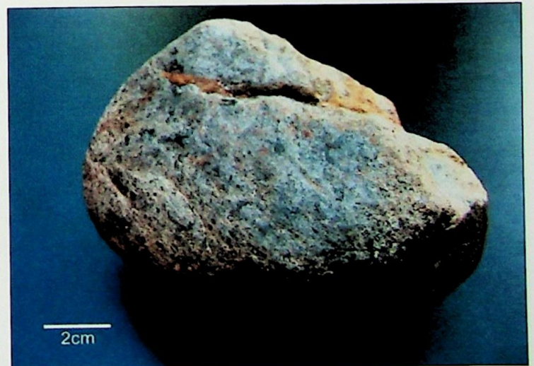
Figura 23. Detalhe das estrias do clasto da Figura 22 evidenciando origem glacial para a fácies CM.
